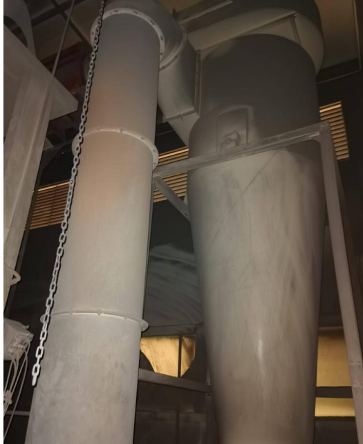
喷粉废气处理设施（旋风+滤芯+布袋装置）
